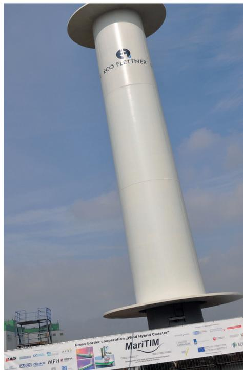
Der Rotor mit dem Namen ECO FLETTNER hat eine Höhe von 18 m und einen Durchmesser von 3 m.
